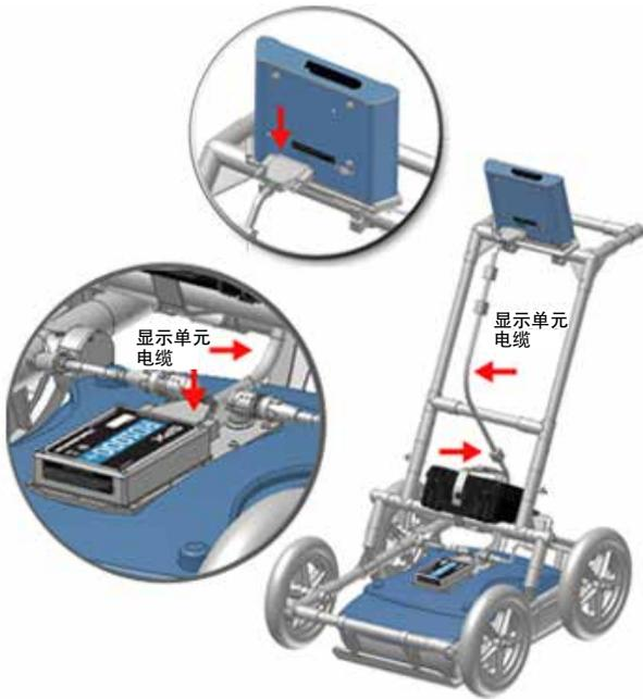
图2.5: 安装电池电缆
